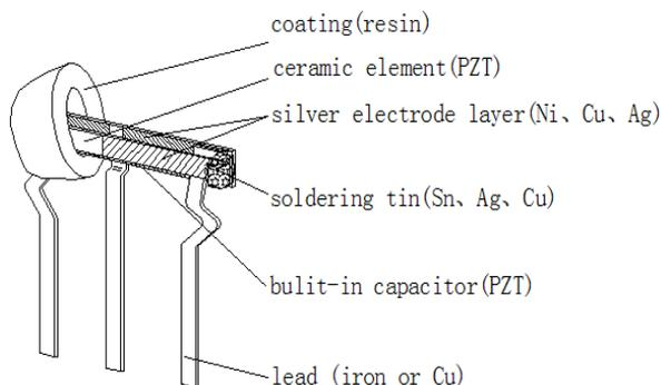
**MHZ THRU-HOLE CERAMIC RESONATOR CRTWS SERIES**
